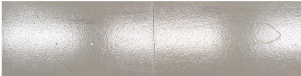
コンポジションタイルに3層塗装した塗膜に、尿を垂らし、一晩乾燥させた。その後、水で濡らしたMFワイプで拭き取った。
